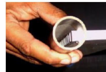
Figura 06: Encaixe da placa de no cano de PVC. (Fonte: Sociedade do Sol, 2009)
