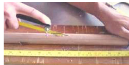
Figura 05: Corte do cano PVC utilizando a tábua de corte. (Fonte: Sociedade do Sol, 2009)
