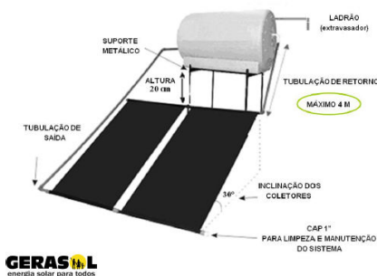
Figura 14: Altura da instalação do sistema e inclinação da placa coletora. (Fonte: Gerasol, 2018)
